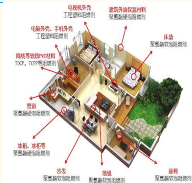
图表 12：建筑用工程塑料
